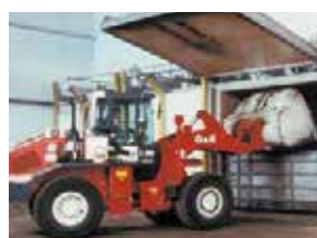
Befüllung der Herhof-Rottebox® per Radlader
