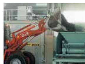
Aufbereitung des Kompostes mittels Siebtechnik
